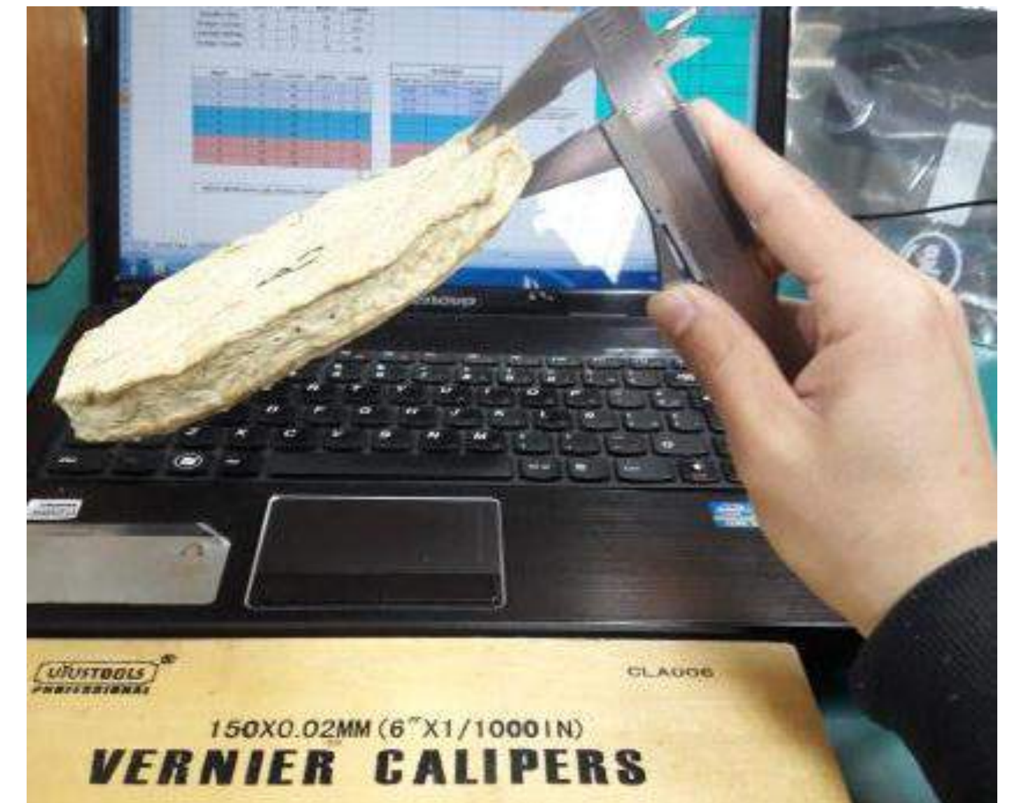
Medición de espesores.
